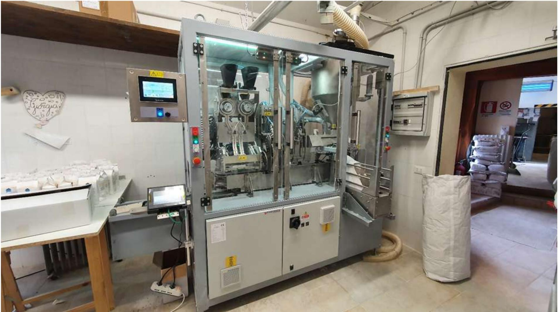
Die Maschine hat ihren Platz in dem für den Absackvorgang vorgesehenen Raum gefunden, zur Zufriedenheit des Kunden und der Bediener, die sich bisher bei der Ausführung der Tätigkeiten abwechseln können, da nur ein Bediener zur Steuerung der Maschine erforderlich ist. Die einzigen Tätigkeiten, die noch auszuführen sind, sind das Laden der leeren Säcke in das Magazin der Maschine und die Bildung von 12er-Bündeln.
