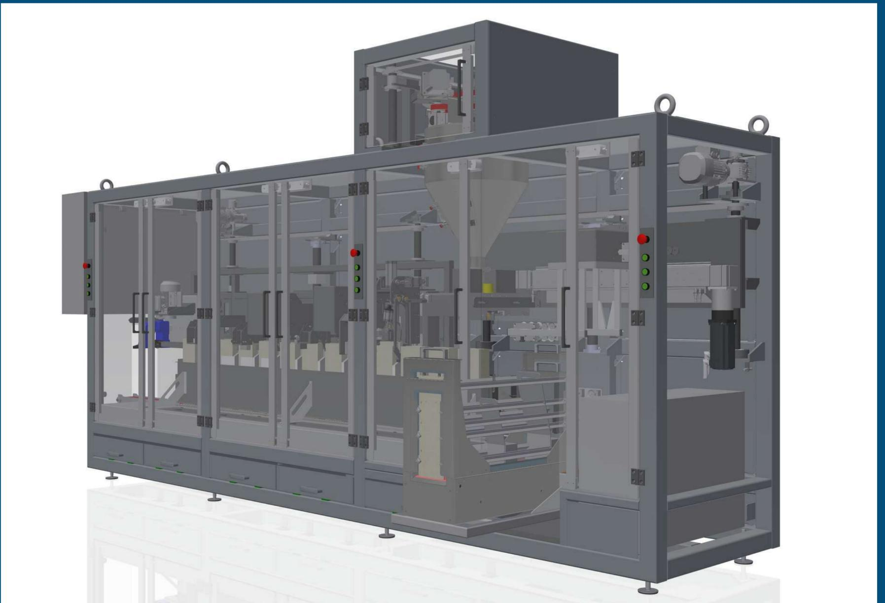
Die Verpackungsmaschine B-30 ist eine Multiformat-Maschine, die für die Verpackung von pulverförmigen Lebensmitteln geeignet ist und einen automatischen Formatwechsel in nur fünfzehn Minuten ermöglicht. Sie verfügt auch über eine doppelte Art des Beutelverschlusses: Doppelflossenfaltung mit Naht und Heißkleber.
